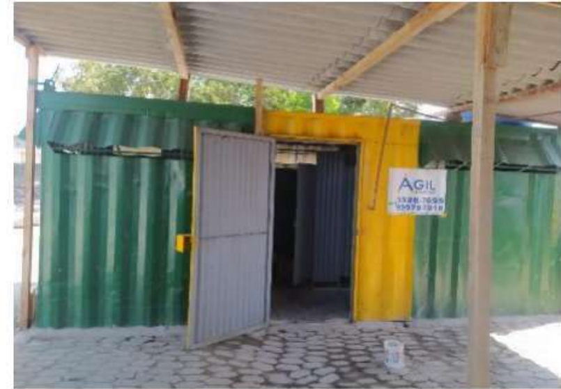
Figura 10 (Item060110 - Aluguel de container tipo sanitário com 3 vasos sanitários, lavatório, mictório, 5 chuveiros, 2 venezianas e piso especial.)
