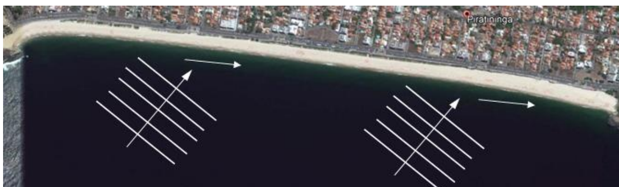
Figura 4 - Transporte longitudinal negativo – ondas chega obliquamente levando sedimentos da direita para a esquerda (observador olhando para o mar)
