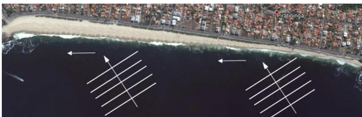
Figura 3 - Transporte longitudinal positivo – ondas chega obliquamente levando sedimentos da esquerda para a direita (observador olhando para o mar)
