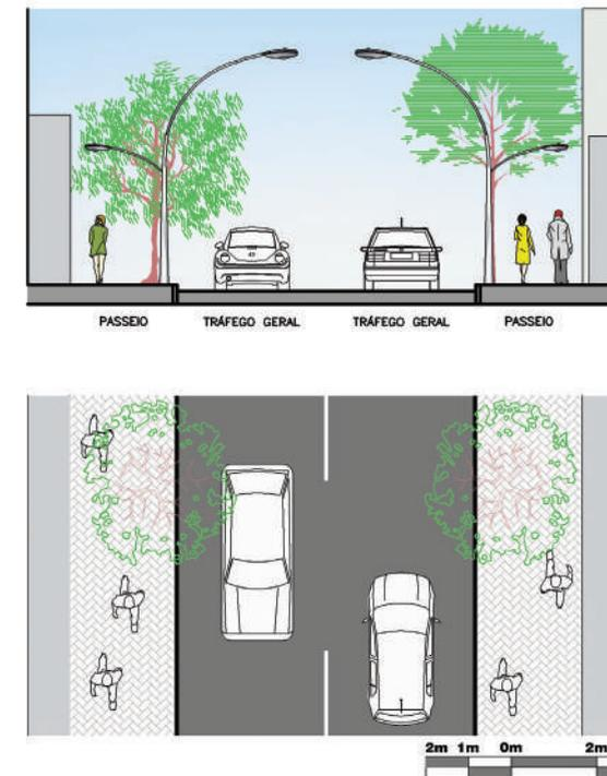
Figura 29: Seção sem parada e sem estacionamento
