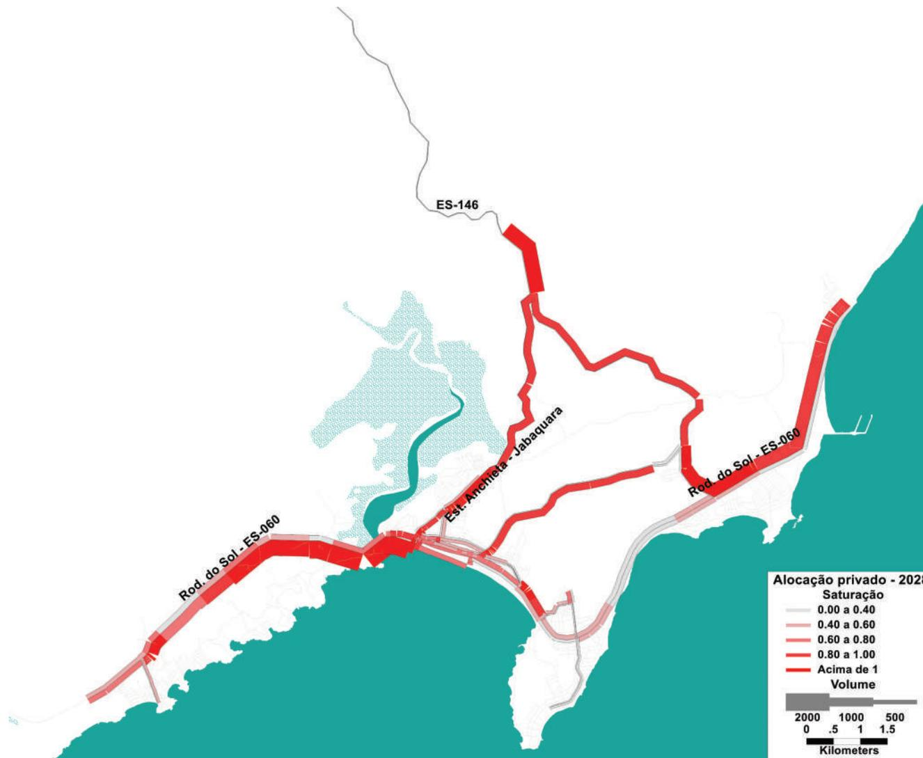
Figura 19: Carregamento e saturação da rede viária de Anchieta em 2028 para o Cenário 2 (Fonte: Análise Logit)
