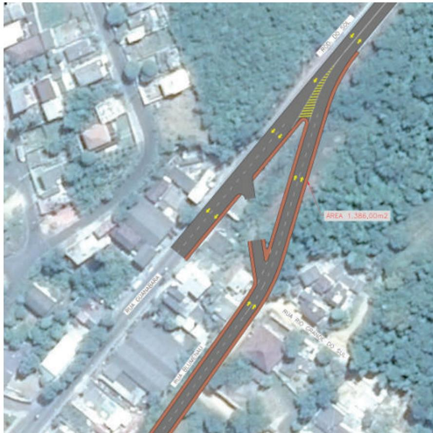
Figura 31: Trecho inicial do binário no extremo leste, com área de desapropriação
