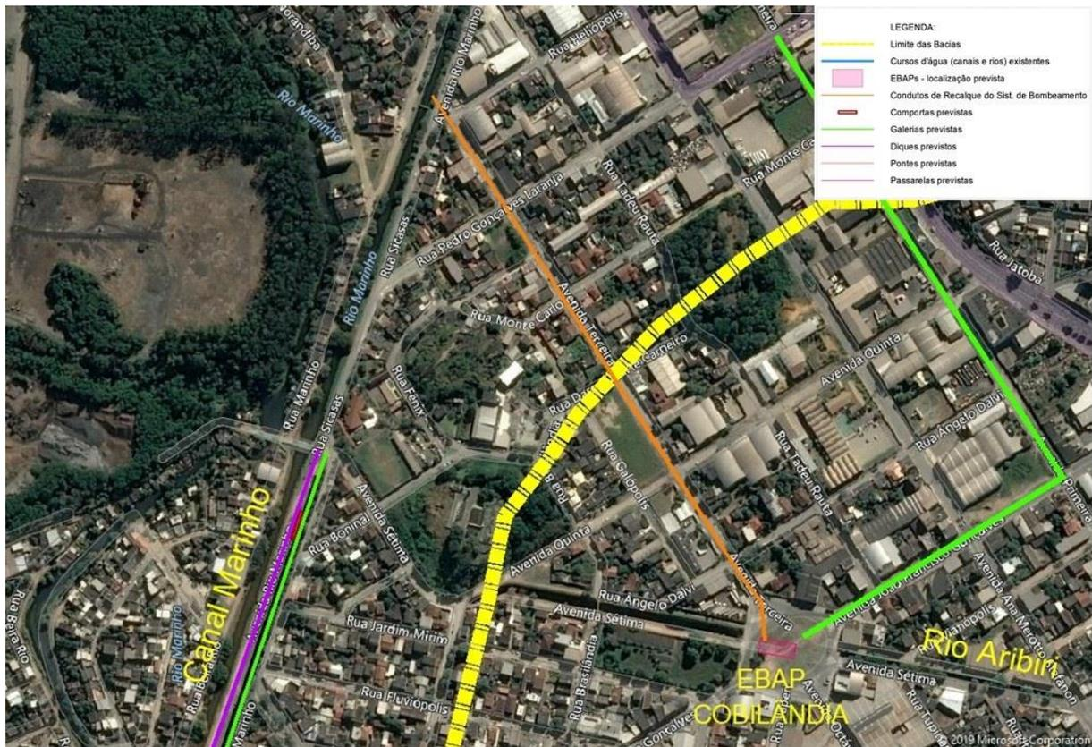
Figura 10 – Linha de recalque da EBAP Cobilândia
