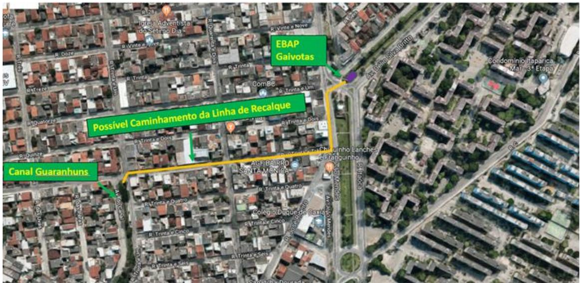
Figura 11 – Linha de recalque da EBAP Gaivotas
