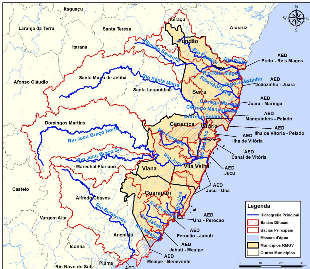
Figura 4 - Ilustração com a divisão inicial das bacias hidrográficas, com a hidrografia existente, que contribuem para a área de estudo (ver desenho detalhado no Capítulo 12).
