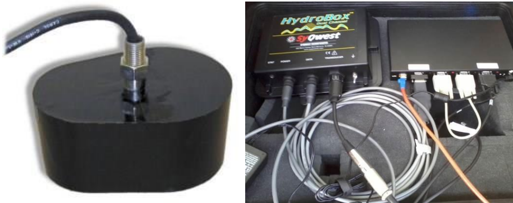
Figura 7 - Ecobatímetro de dupla frequência Hidrobox Syqwest.
