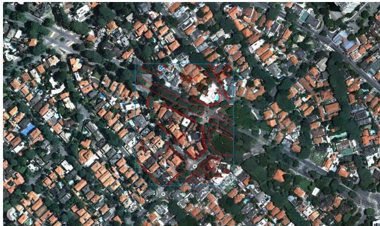
Figura 9 - Exemplo de uma amostra e a determinação da área impermeável, na Bacia do Alto Tietê (PDMAT3).
