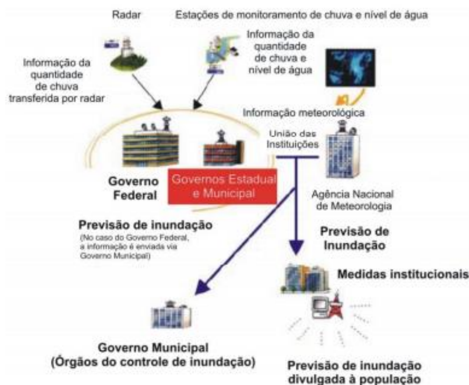
Figura 9-1 - Estrutura esquemática de uma rede de monitoramento e previsão de alerta.
