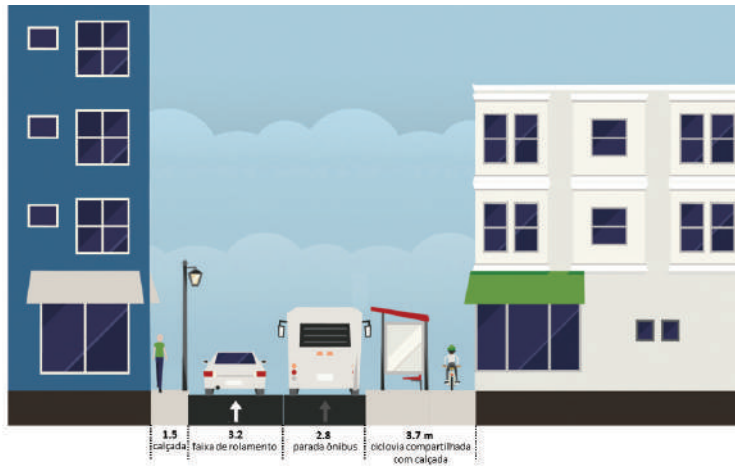
Figura 55: Seção tipo R. Prof. Lobo - ponto de ônibus Fonte: Elaboração LOGIT ( http://www.streetmix.net/ )
