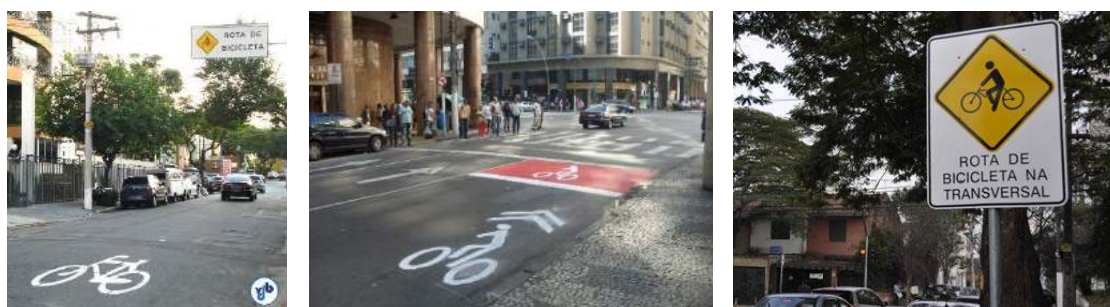
Figura 228 – Exemplos de sinalização de ciclorrota
