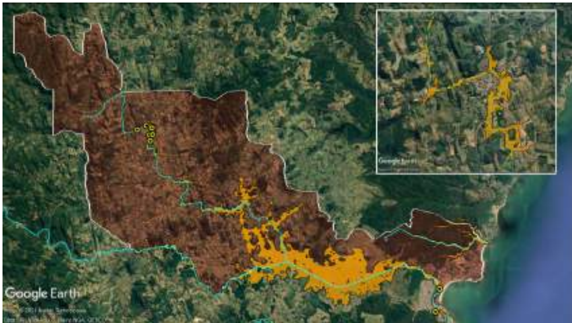
Figura 170 – Pontos críticos associados à inundação de corpos hídricos de macrodrenagem (círculos amarelos) e manchas de inundação obtidas da simulação para o ano de 2020 com chuva de projeto para o período de retorno de 100 anos, Município de Fundão.
