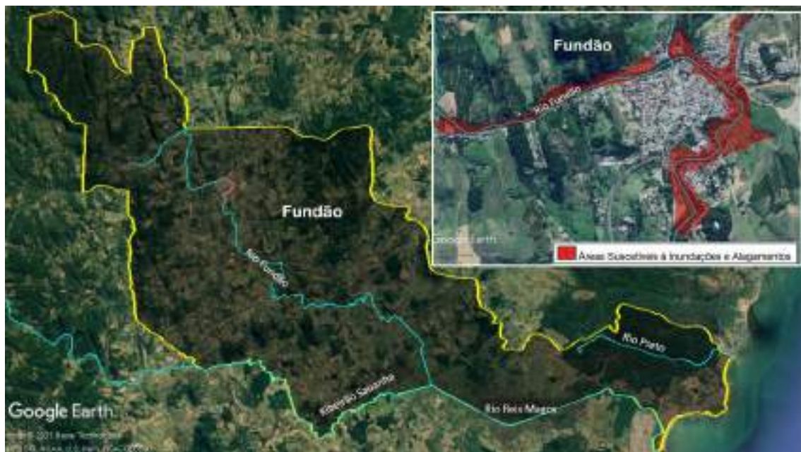
Figura 40 - Rede de drenagem e as áreas sujeitas a riscos de inundação no Município de Fundão.
