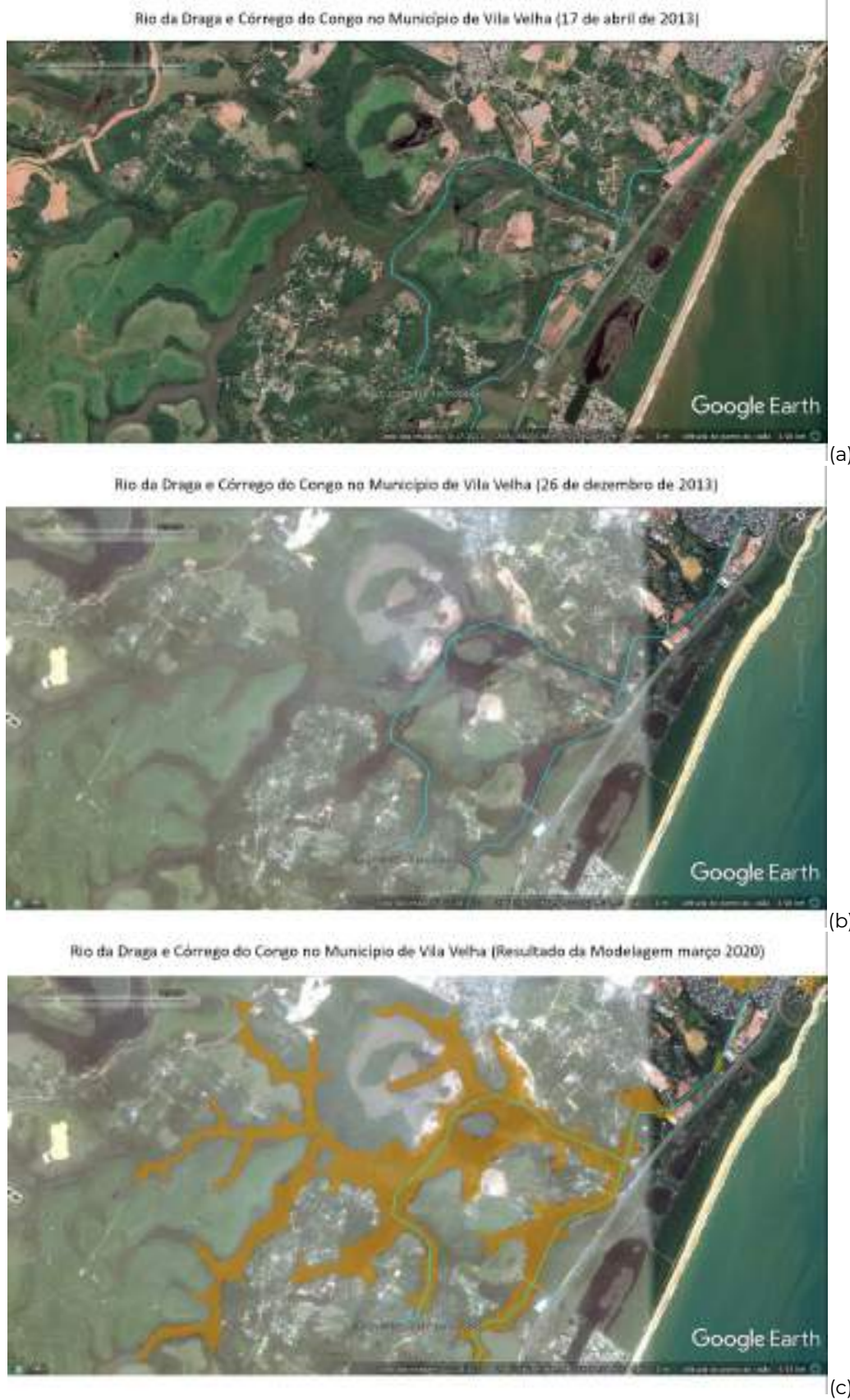
Figura 162 –Município de Vila Velha. (a) sem inundação, (b) inundação em dez. 2013 e (c) simulação mar. 2020.
