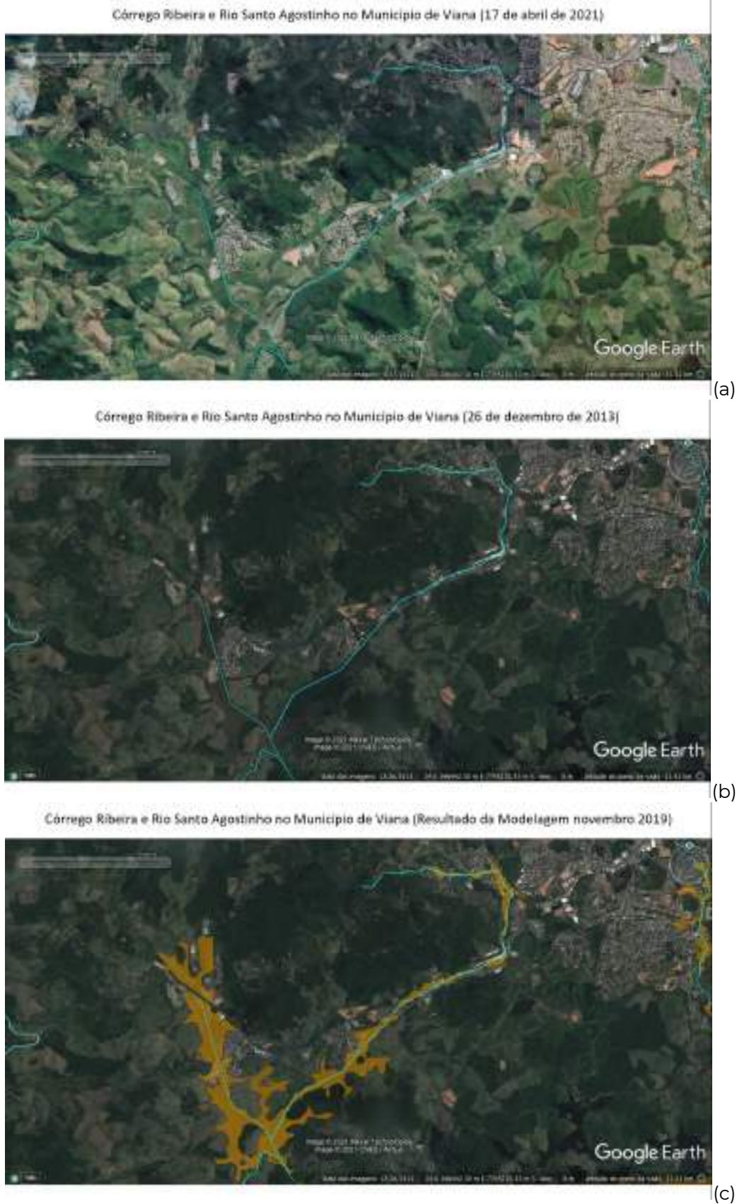
Figura 158 –Município de Viana. (a) sem inundaç o, (b) inundaç o em dez. 2013 e (c) simulaç o nov. 2019.
