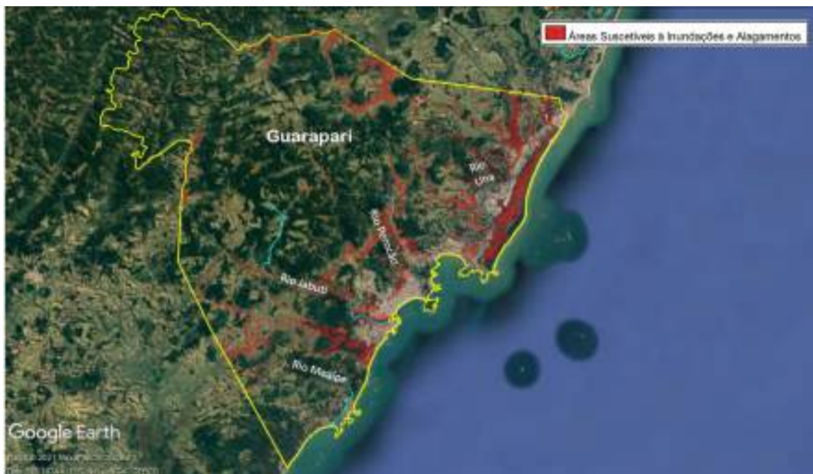
Figura 42 - Rede de drenagem e as áreas sujeitas a riscos de inundação no Município de Guarapari.
