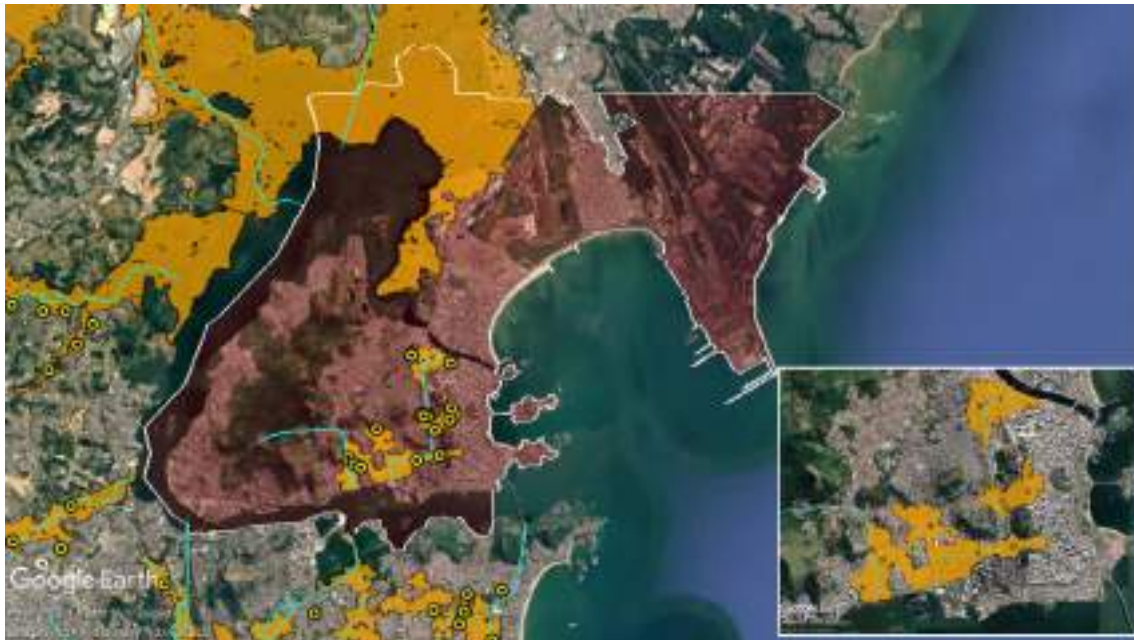
Figura 168 – Pontos críticos associados à inundação de corpos hídricos de macrodrenagem (círculos amarelos) e manchas de inundação obtidas da simulação para o ano de 2020 com chuva de projeto para o período de retorno de 100 anos, Município de Vitória.
