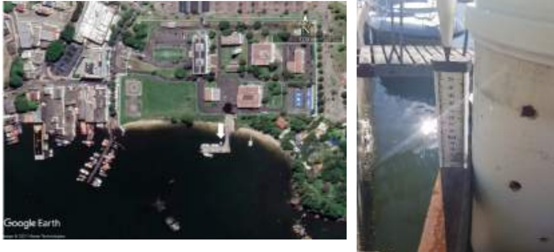
Figura 109 – Nivelamento da régua do marégrafo da Capitania dos Portos do ES.
