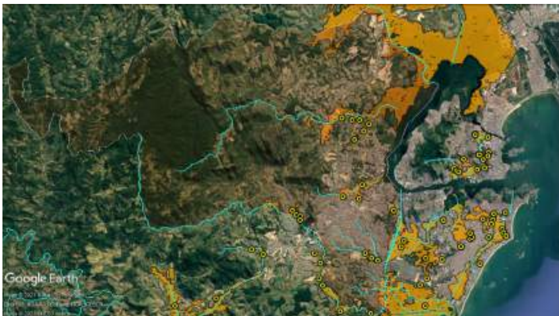
Figura 167 – Pontos cr ticos associados   inundaç o de corpos h dricos de macrodrenagem (c rculos amarelos) e manchas de inundaç o obtidas da simulaç o para o ano de 2020 com chuva de projeto para o per odo de retorno de 100 anos, Munic pio de Cariacica.
