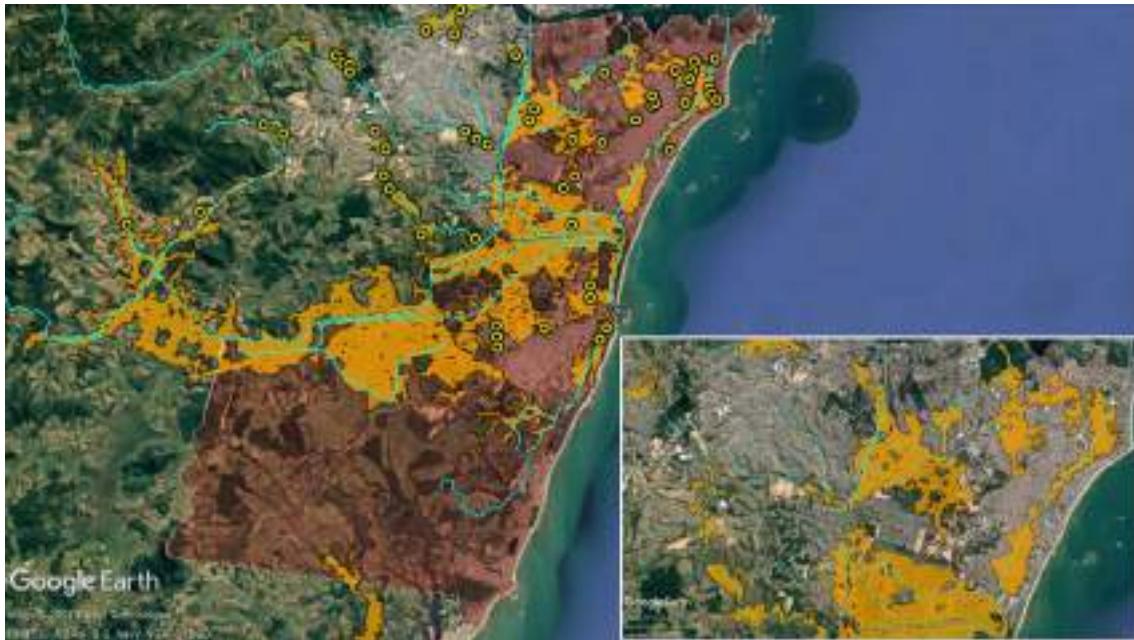
Figura 166 – Pontos críticos associados à inundaç o de corpos h dricos de macrodrenagem (c rculos amarelos) e manchas de inundaç o obtidas da simulaç o para o ano de 2020 com chuva de projeto para o per odo de retorno de 100 anos, Munic pio de Vila Velha.
